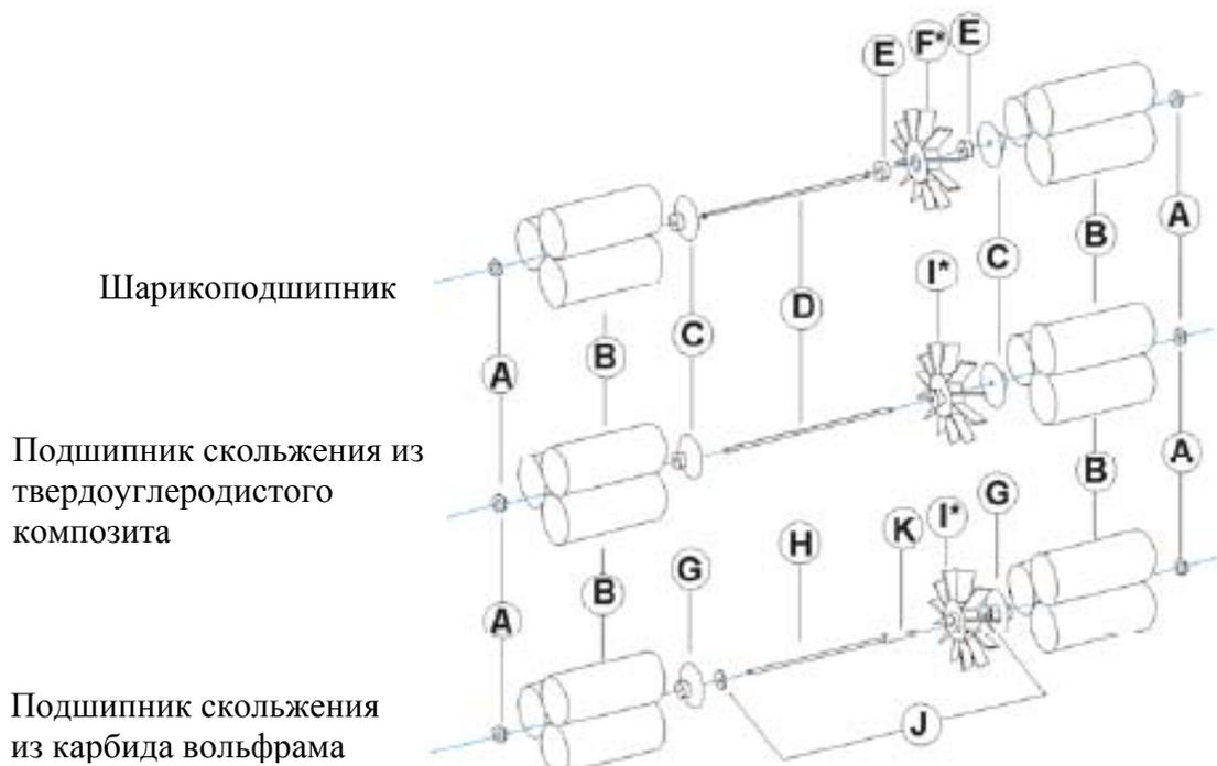
\*количество лопастей ротора, угол их наклона и длина зависят от назначения и размера турбины
