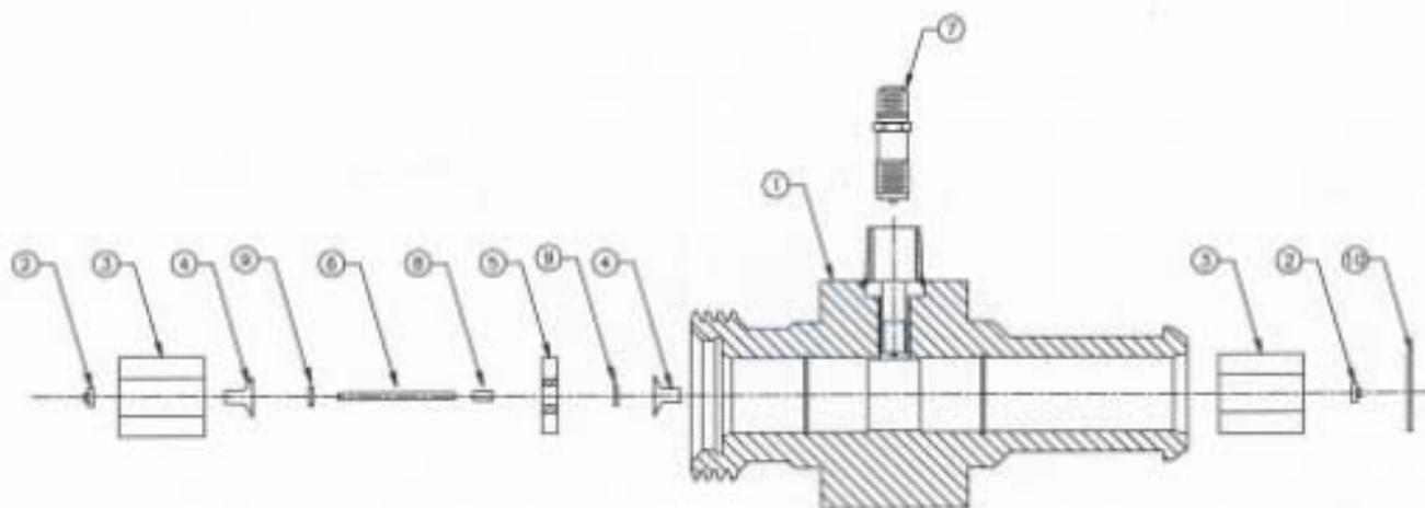
Расходомер Wing Nut с подшипниками скольжения из композита вольфрама ТС
